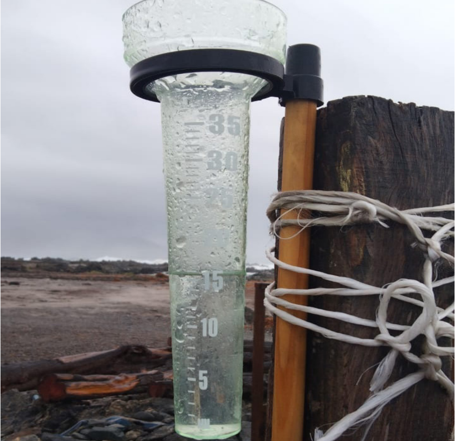
Pluviómetro artesanal en Los Bronces (Foto:Aroldo Torres Barraza)
