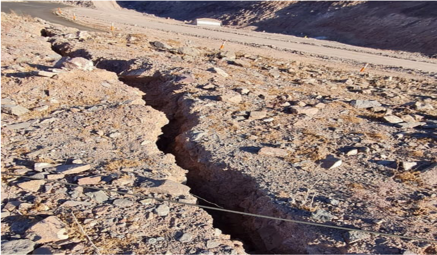
Los puntos más relevantes del informe técnico señalaban que las fracturas se desarrollan en una unidad geológica cuaternaria con persistencia en la formación volcánica "Fm Cerrillos",
